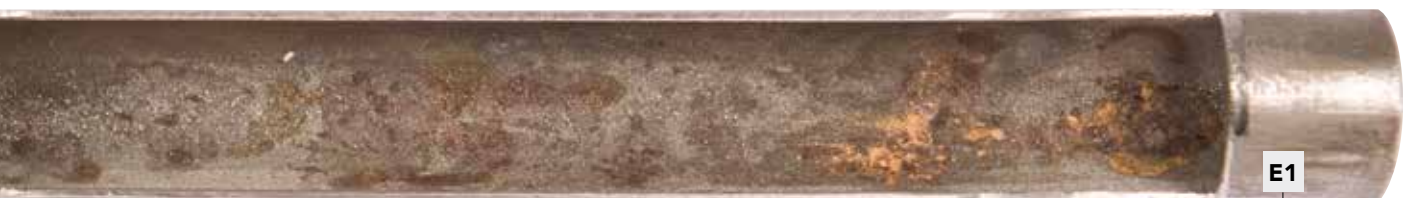
IK-Befall; starke Korrosion
