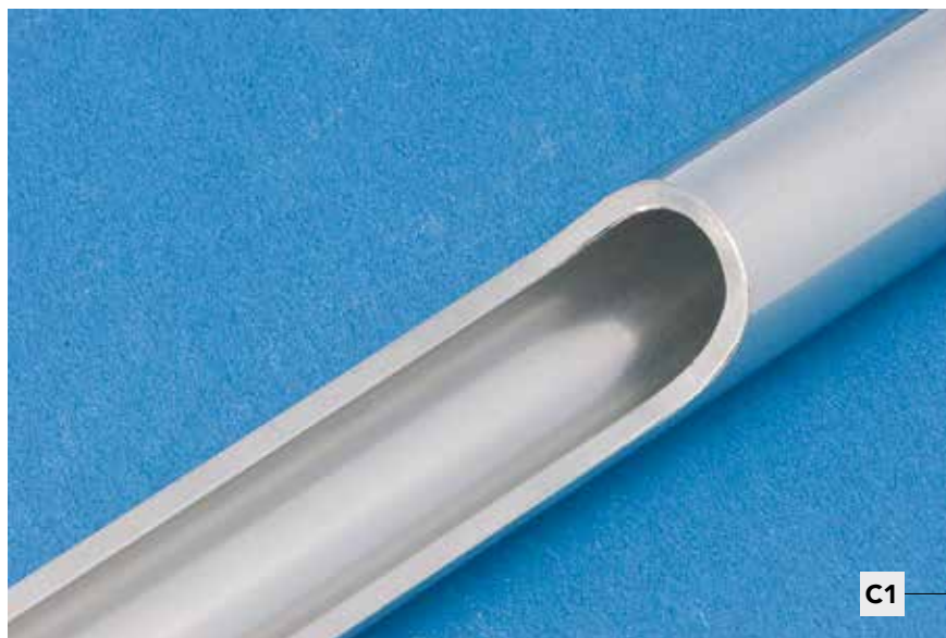
TPS SBS Level 2 innen walzpoliert Rauigkeit innen und außen Ra max. 0,8 µm
