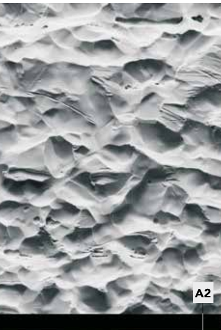
gebeizte Innenoberfläche Rauigkeit Ra ca. 2,5 µm
