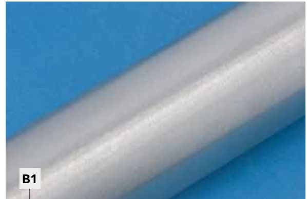
geschliffene Außenoberfläche Rauigkeit Ra ca. 2,0 µm
