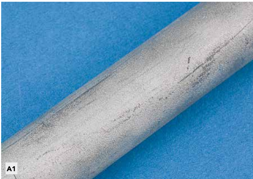
gebeizte Außenoberfläche Rauigkeit Ra ca. 2,5 µm
