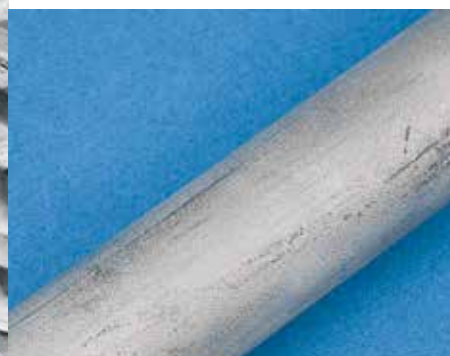
roughness Ra approx. 2,5 µm
